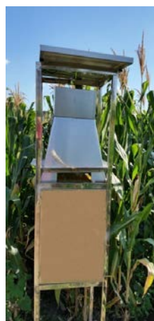
b 自动更换粘虫板的害虫自动监测装置
