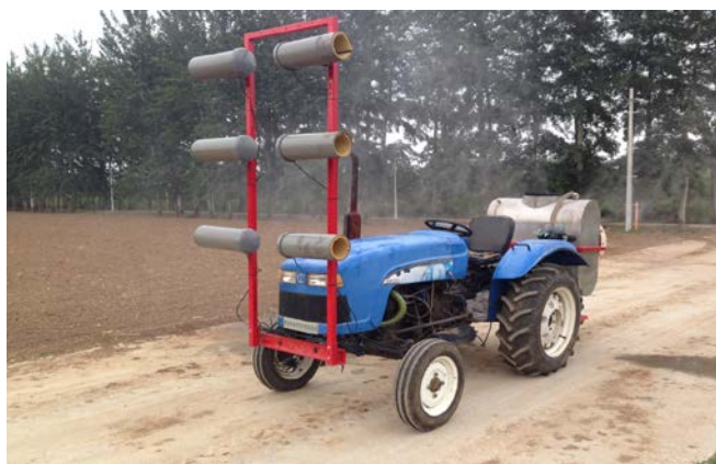
图 5-2 基于超声靶标探测的对靶喷药机
