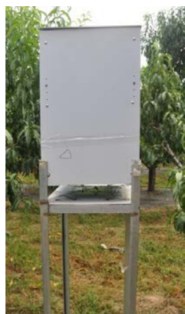
a 简易害虫自动监测装置
