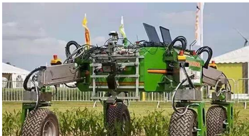
图 4-2 德国博世公司的 BoniRob 农业信息采集机器人
