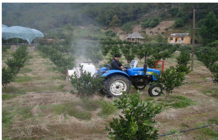
图 5-1 基于红外靶标探测的对靶喷药机
